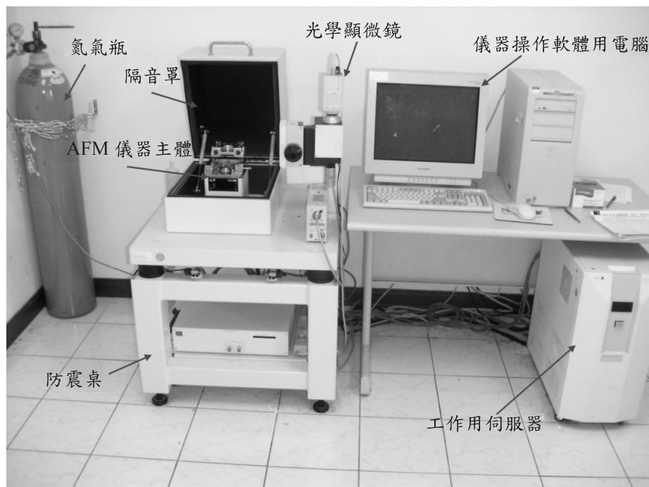
圖 1-4 AFM 儀器全景
