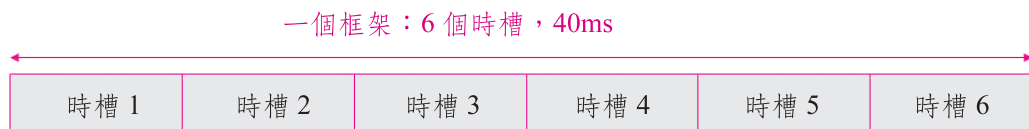
圖 1.5(甲) D-AMPS 框架結構
