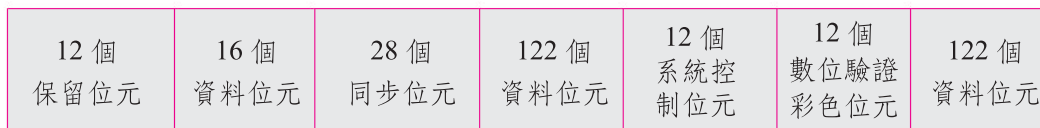
圖 1.5(丙) 上鏈路 D-AMPS 時槽結構
