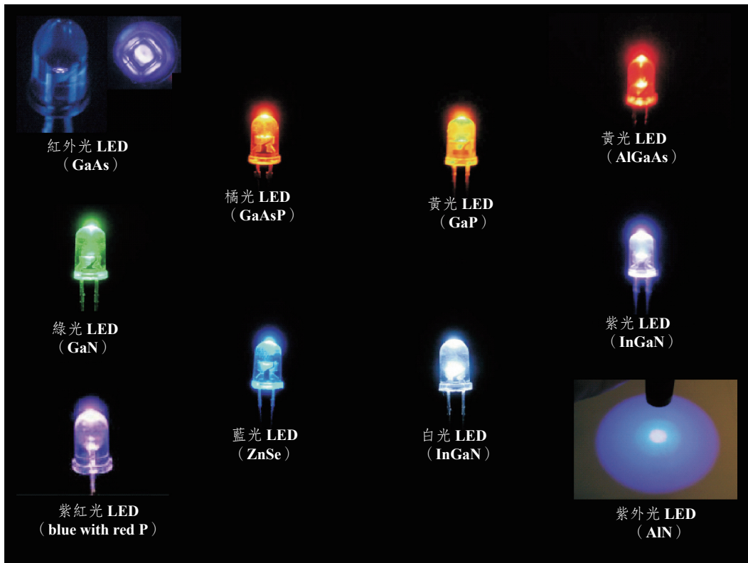
圖 1.1 不同材料和與其相對應的波長之封裝好的LED照片
